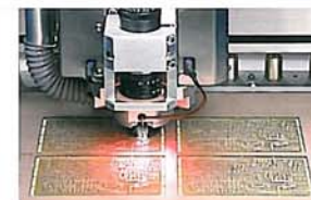
Circuito PCB cortado y taladrado
